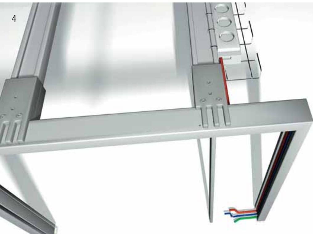
Schema dettaglio elettrificazione
